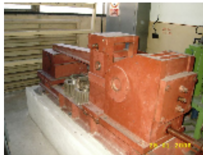
Mașina de încercat la oboseală de încovoiere a danturii roților dințate
