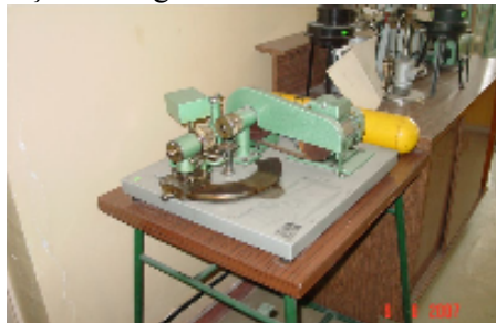
Stand pentru determinarea rezistenței la oboseală a maselor plastice
